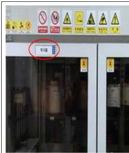
화학물질을 저장 및 보관하는 가장 좋은 방법은 밀폐 환기형 방폭캐비닛을 이용하여 보관하여야 한다. 하지만 고가의 장비이기 때문에 대부분 책장 또는 진열장 형태의 시약장을 구비하고 있다. 이때 연구활동 종사자가 찾기 편하기 위하여 ABC순 배치를 하여 구분, 보관 하는데 이때 시약이 혼재 될 우려가 있다. 따라서 화학 물질은 알파벳순이 아닌 성상별 분류 보관 조치하여야 한다.
