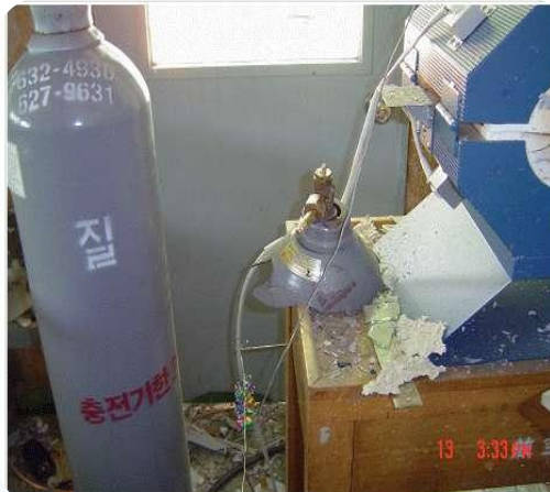
과산화 수소 분해 실험 중 가스누출 및 폭발 1명 사망, 1명 중상(2003.05)
