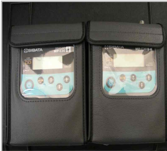
[사진1] TVOC 측정 펌프
