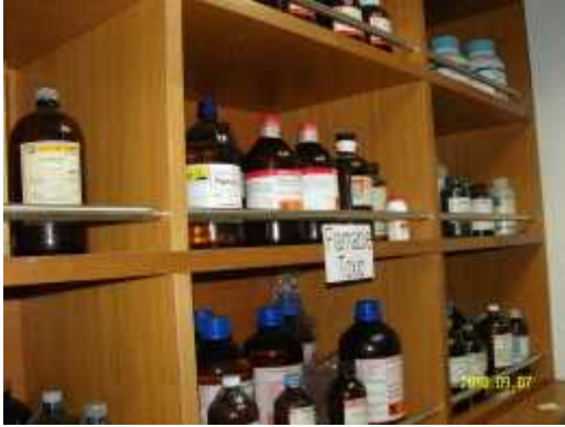
<사진1. 전도방지가드 설치>
